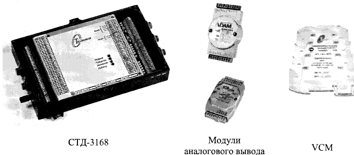
Рисунок 5 - Внешний вид преобразователя виброизмерительного вторичного СТД-3168, модуля аналогового вывода и преобразователя сигналов VCM
