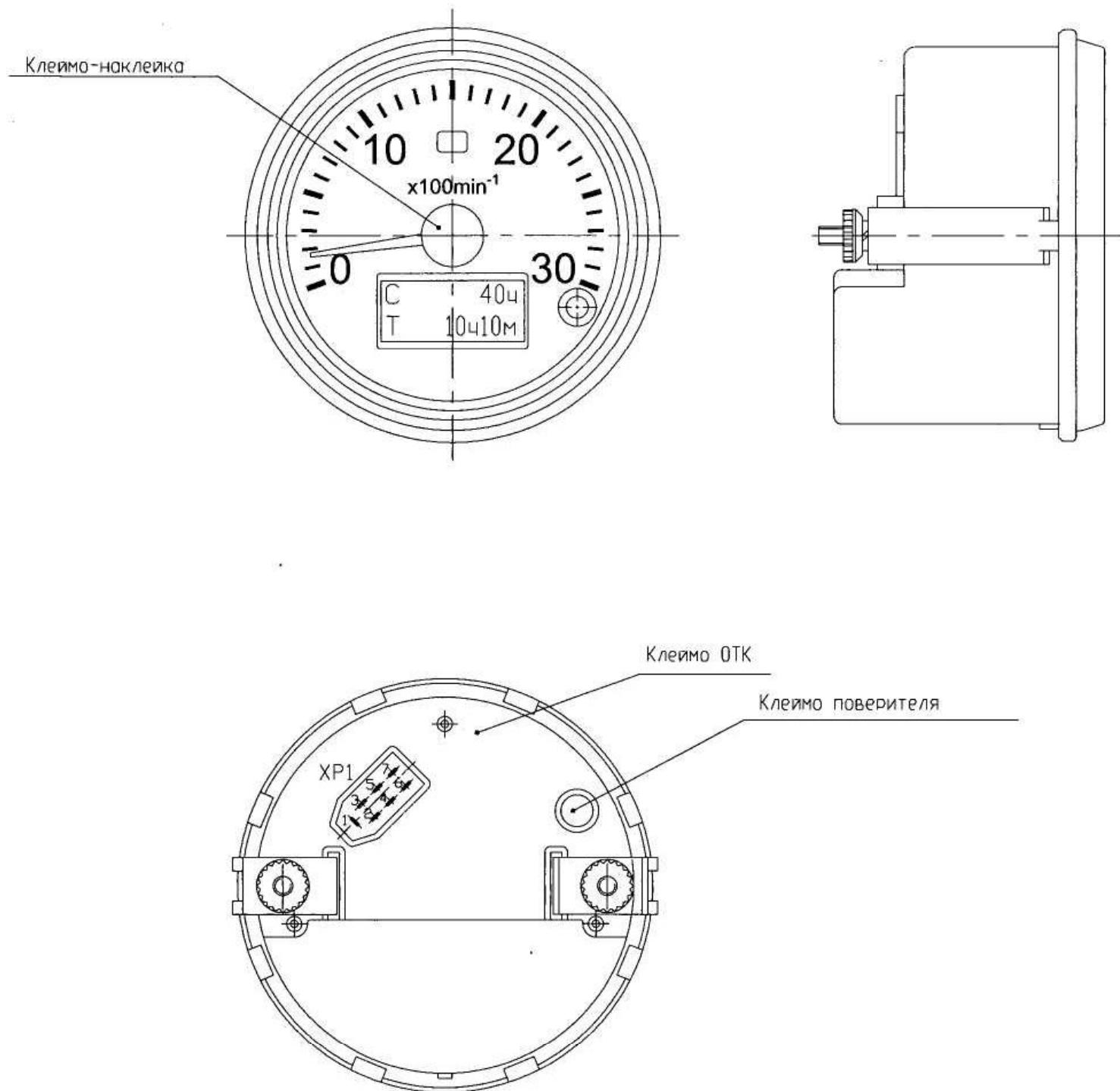
Рисунок А.1- Общий вид, схема пломбировки, указание места для нанесения
