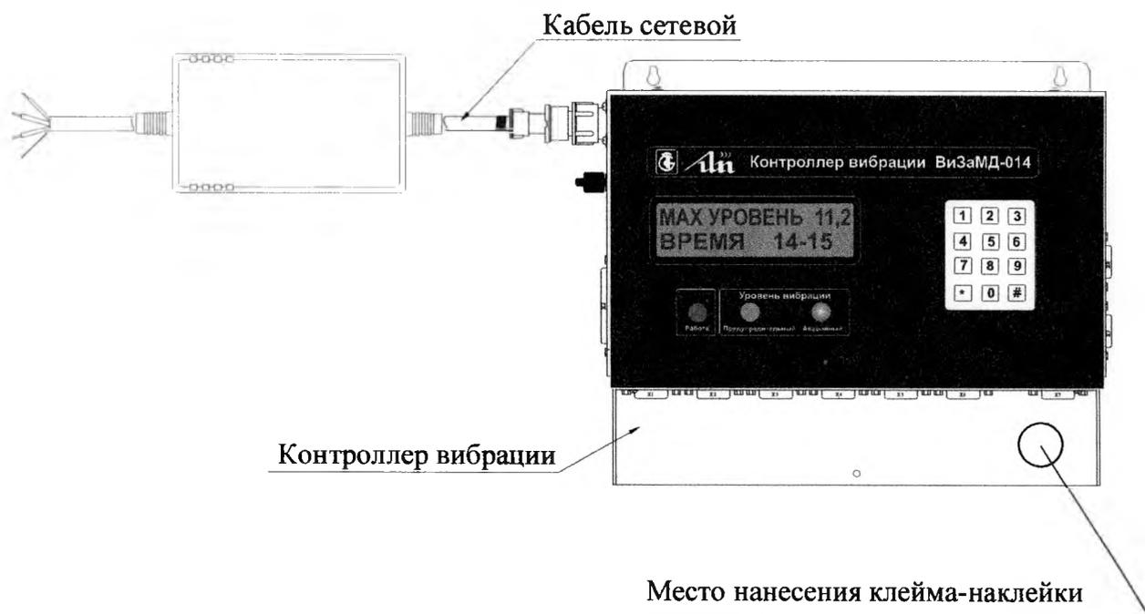
Рисунок А.1 – Место нанесения клейма-наклейки
