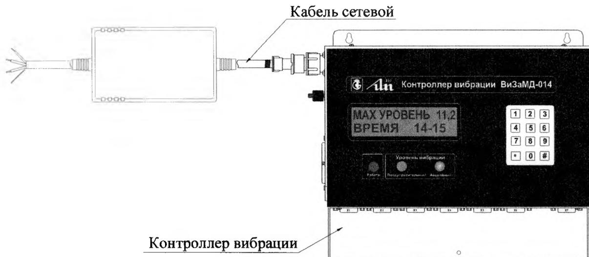
Рисунок 1 - Внешний вид контроллера вибрации
