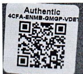
Рисунок 1.2 – Фотография маркировки манометра дифференциального показывающего Magnehelic 2000-500PA № 4CFA-ENMB-GMGP-VDET
