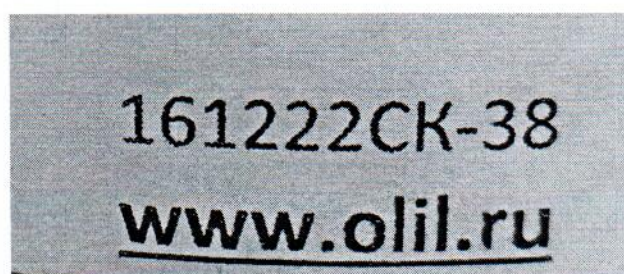
Рисунок 1.2 – Фотография маркировки манометра дифференциального показывающего Magnehelic 2000-60РА № 161222СК-38
