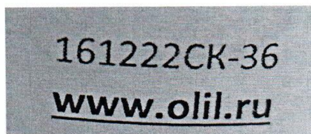
Рисунок 1.2 – Фотография маркировки манометра дифференциального показывающего Magnehelic 2000-60РА № 161222СК-36
