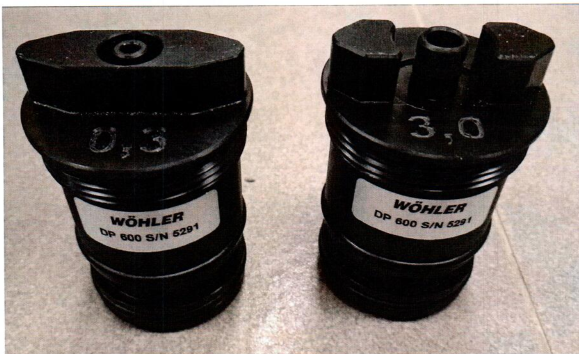
Рисунок 1.3 – Фотография общего вида и маркировки адаптеров «0,3» и «3,0» из комплекта прибора
