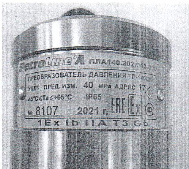
Рисунок 9 – Место нанесения заводского номера преобразователей
