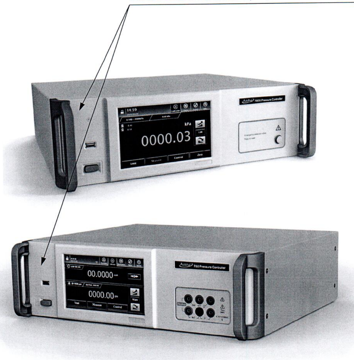
Рисунок А.1 – Место нанесения знака поверки (клеймо-наклейка)
