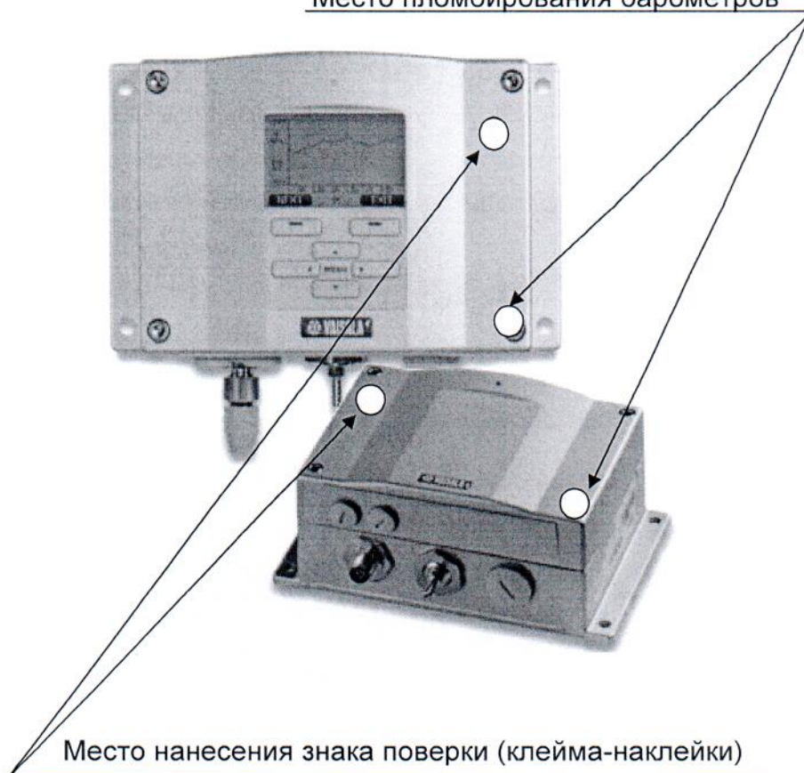
Рисунок А.1 – Места пломбирования и нанесения знака поверки (клейма-наклейки)
