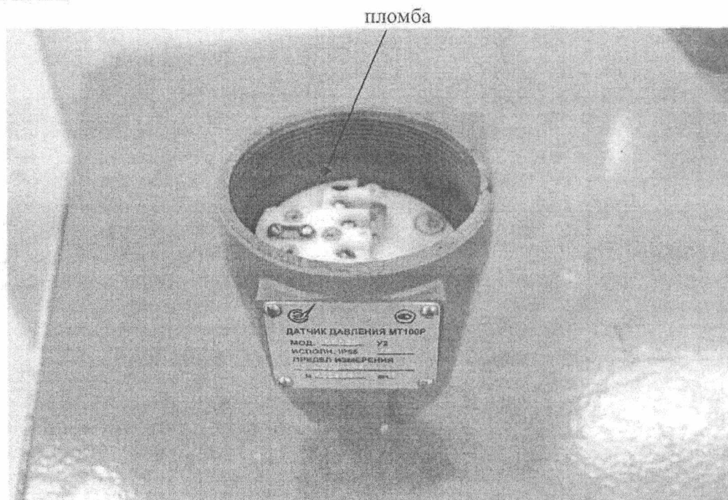
Рисунок 2 - Пломбирование датчиков давления МТ 100
