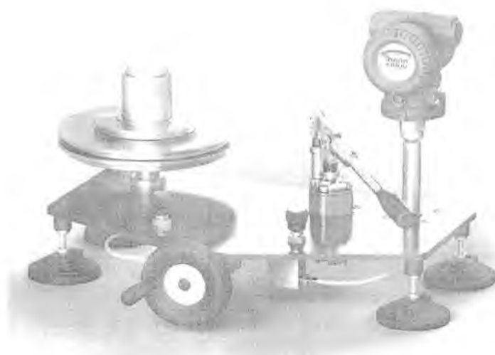
Рис. 2. Манометры газовые грузопоршневые МГП-2,5; МГП-10; МГП-100
