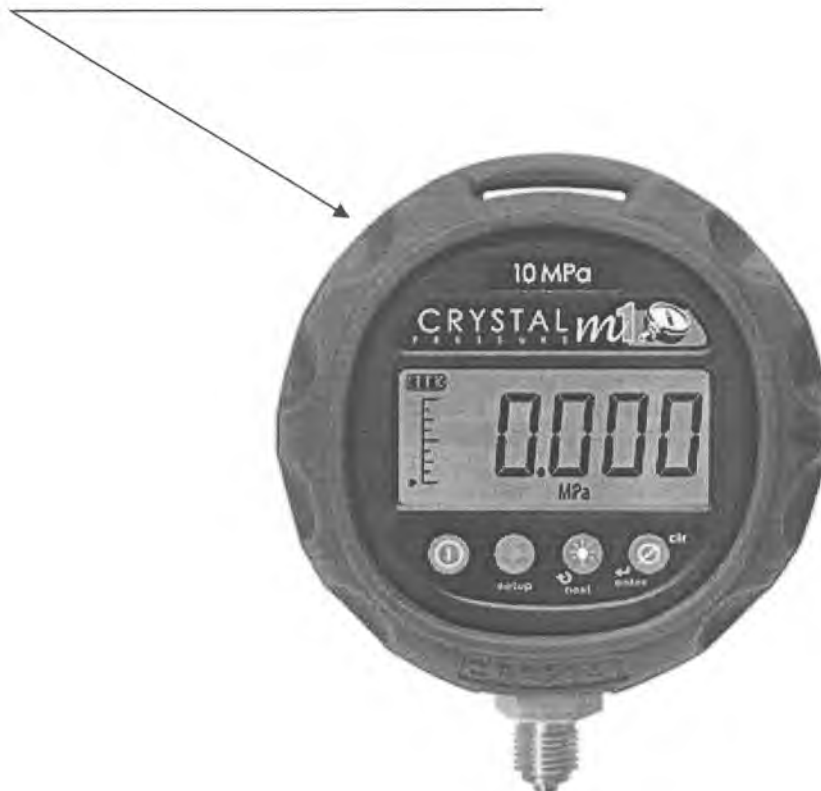
Рисунок А.2. Внешний вид манометров цифровых М1 и место нанесения знака поверки в виде клейма-наклейки
