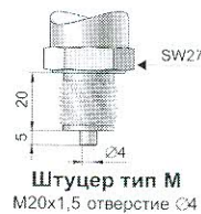
Рисунок 1 - Внешний вид, габаритные и установочные размеры преобразователей давления измерительных APC-2000
