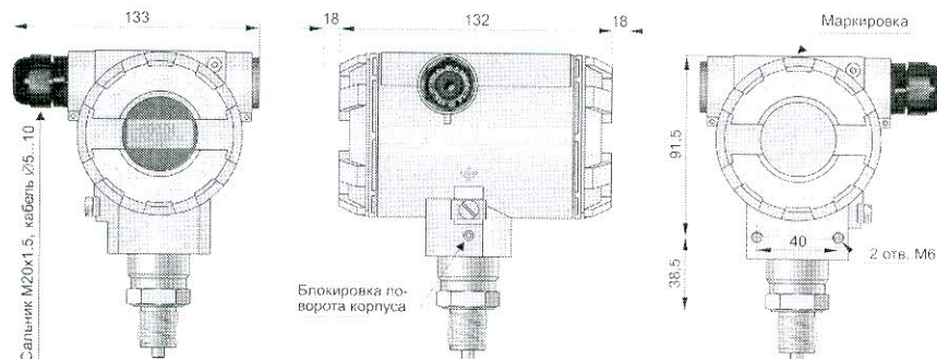
Преобразователь исполнения AL Пример с встроенным индикатором
