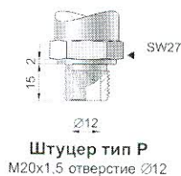
Рисунок 1 - Внешний вид, габаритные и установочные размеры преобразователей давления измерительных APC-2000
