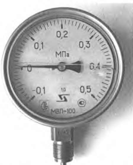
мановакуумметр MBP-100 с жидкостным наполнением
