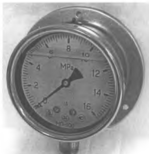
манометр железнодорожный MP100MD/Фз-Дм-Жд с жидкостным наполнением
