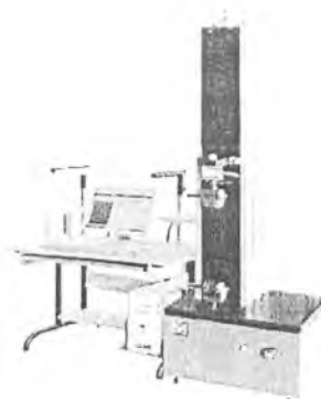
Рисунок 1. Общий вид машины испытательных универсальных РЭМ, выпускаемых в одноколонном исполнении.
