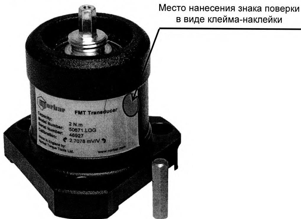
Рисунок А.1 - Схема нанесения знака поверки преобразователей
