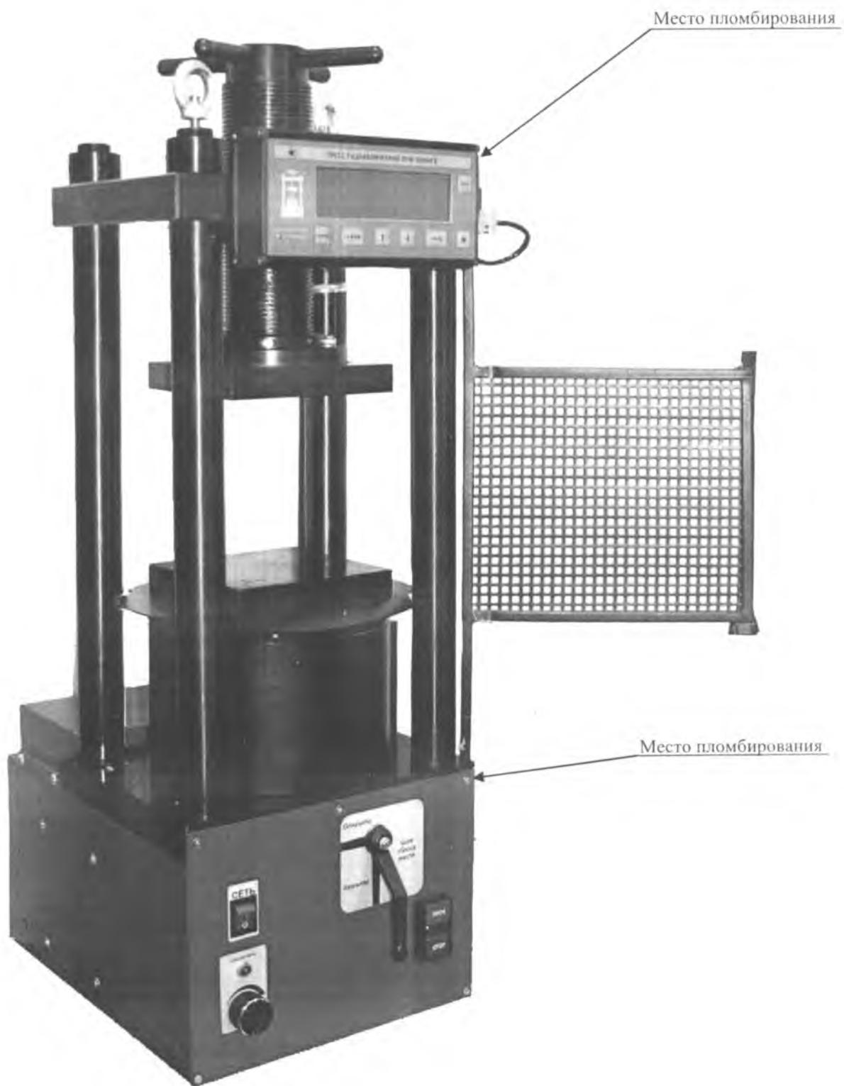
Рисунок 1 – Пресс гидравлический малогабаритный ПГМ-МГ4
