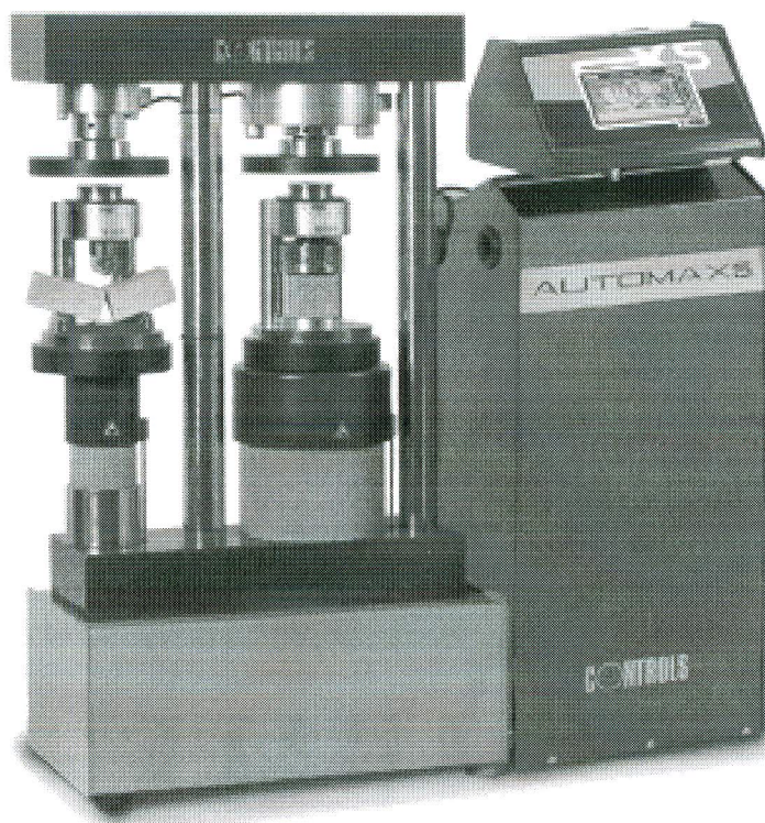
Рисунок 1. Машина силоизмерительная для испытаний строительных материалов серии L исполнения 65-L1352.
