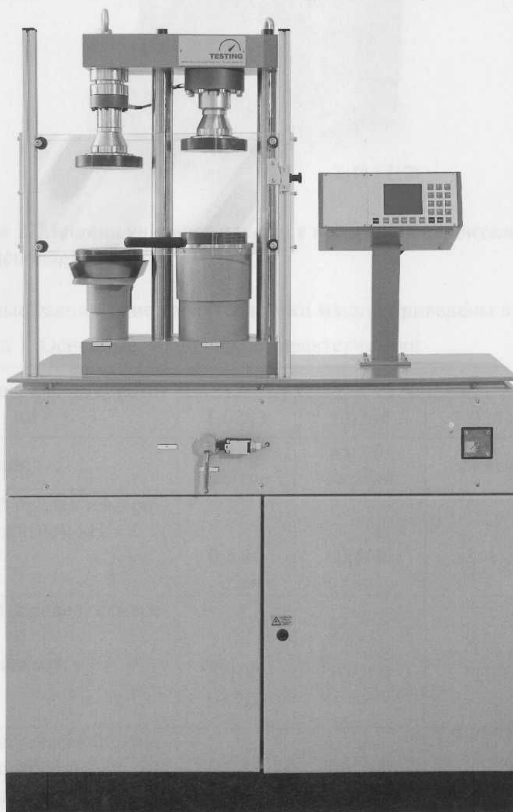
Рисунок 1. Машина универсальная для испытаний строительных материалов серии 1 исполнения 1.0244
