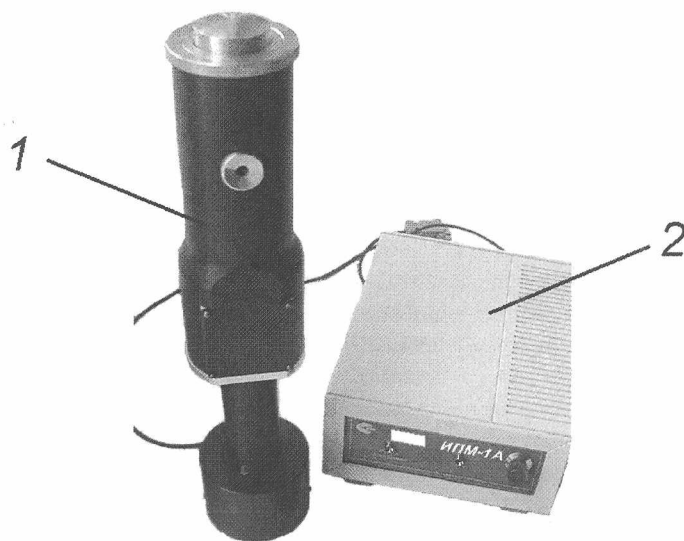
Рисунок 1 – Внешний вид базовой модели ИПМ-1А: 1 – ударный преобразователь, 2 – электронный блок АЦП
