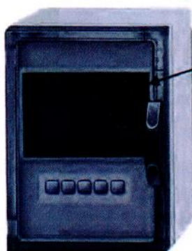
Схема пломбировки BW500
