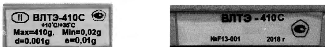
Рисунок 4 – Маркировка весов
