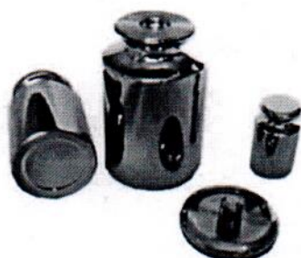
Рисунок 4.Гири с отвинчивающейся головкой
