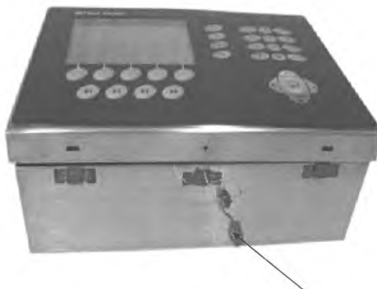
Место пломбировки терминала б) настольного исполнения
