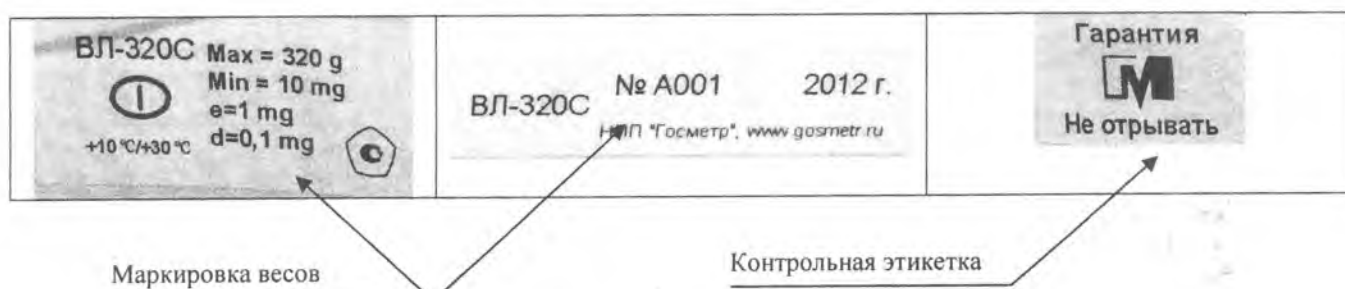
Рисунок 2 - Схема пломбирования от несанкционированного доступа и маркировка весов
