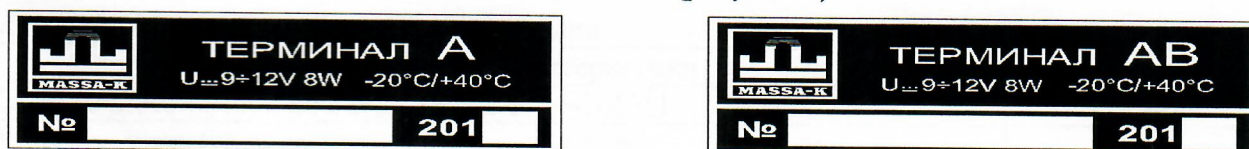
Рисунок 8 – Примеры маркировки терминала
