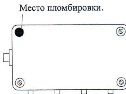
Рисунок 3 - Схема пломбировки соединительной коробки от несанкционированного доступа
