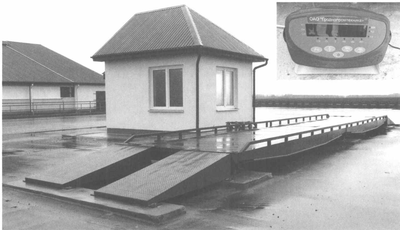
Рисунок 1 – Внешний вид весов электронных автомобильных ВАБм
