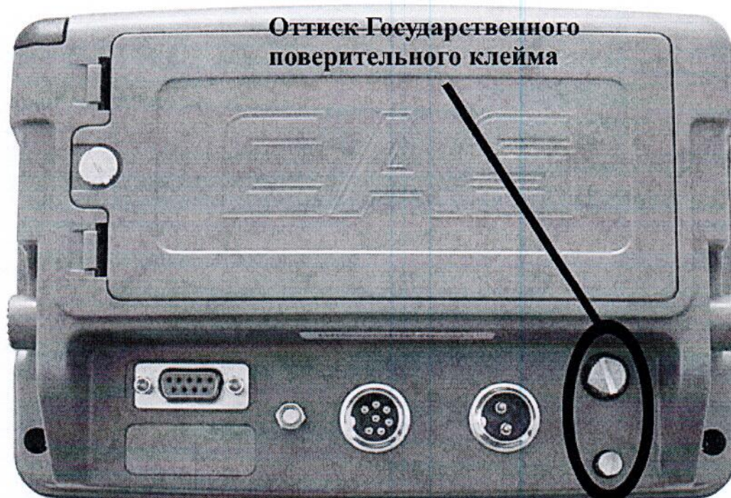
Рисунок А.1 – Схема пломбирования показывающего устройства СІ-200А
