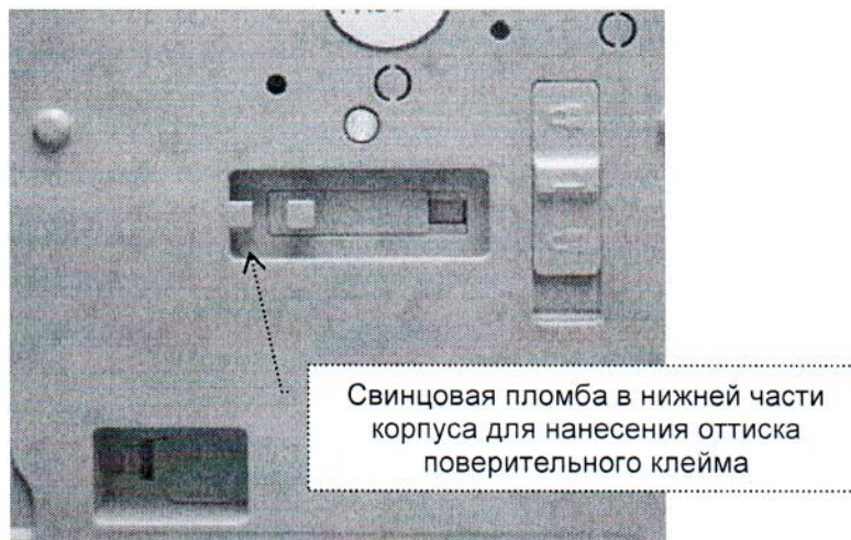
Рисунок А.1 – Схема пломбировки весов лабораторных ХЕ
