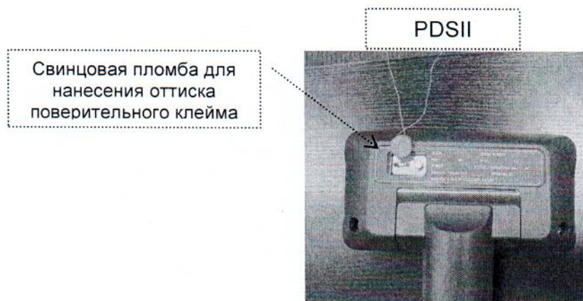
Рисунок А.6 – Схема пломбировки весов общего назначения PDSII
