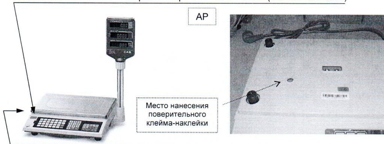
Рисунок А.1 – Схема пломбировки весов торговых AP
