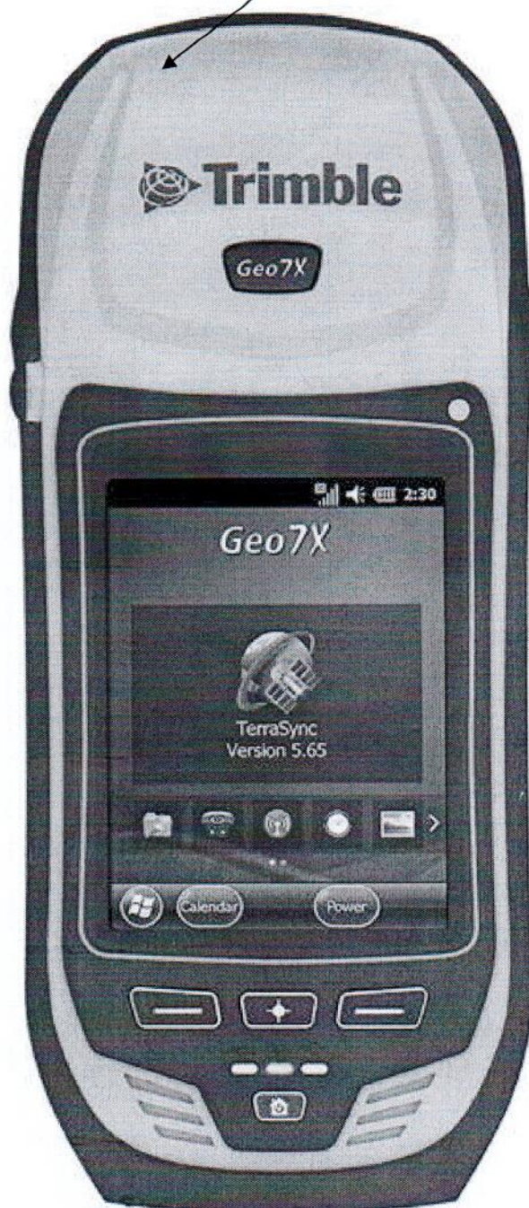
Рисунок А.1 – Место нанесения знака поверки в виде клейма-наклейки
