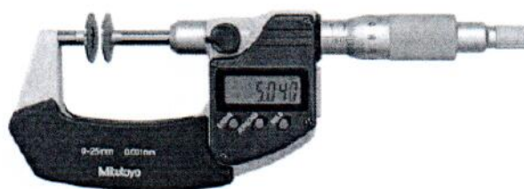
Рисунок 6.2 - Внешний вид дискового микрометра Digimatic серии 369 с невращающимся микровинтом
