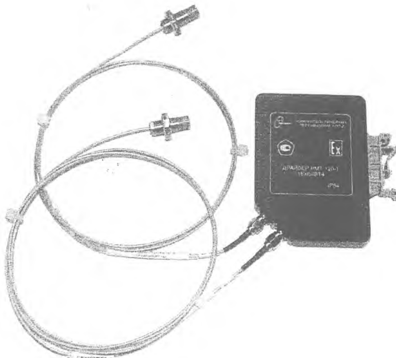
Рисунок 2 - Внешний вид первичных вихретоковых преобразователей и измерителя перемещения (драйвера) РМТ
