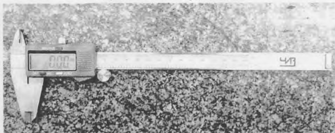
Рисунок 5 – Штангенциркуль ШЦЦ-I.
