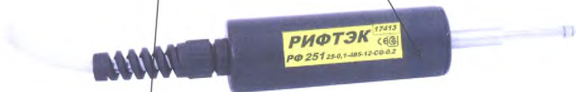
Рисунок А.2 Место нанесения знака поверки на преобразователь PΦ251-25
