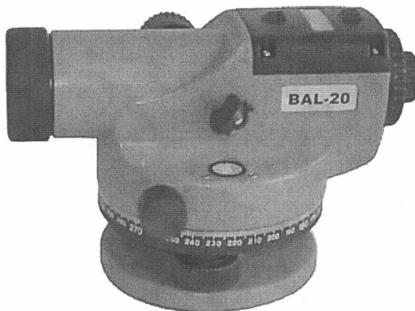
Рисунок 1 – Внешний вид нивелира BAL
