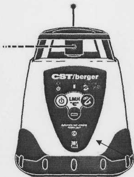
Рисунок 6 – Схема пломбировки нивелиров лазерных LMH
